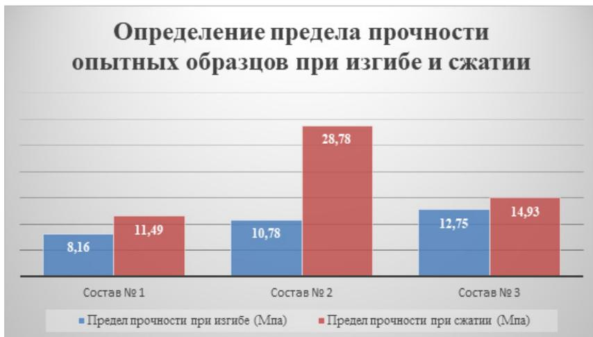
*Определение прочности опытных образцов при изгибе и сжатии*
